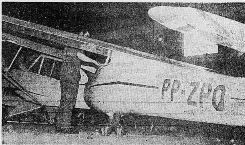
O planador tem quinze metros, pesa 164 quilos e foi construído em aço especial para aviação.
